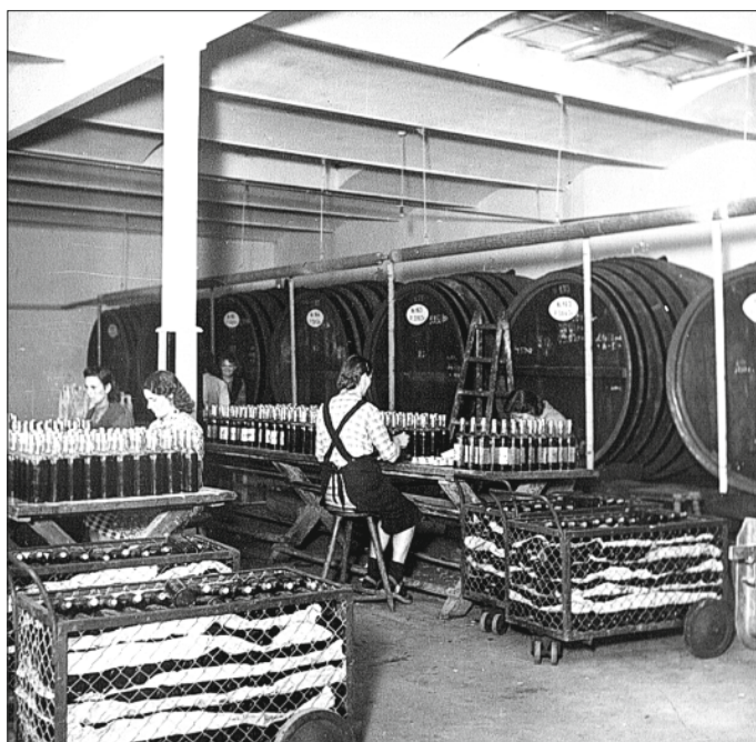
Il. 4. Proces etykietowania i pakowania butelek w tzw. wykończalni, fot. ze zb. Muzeum Ziemi Lubuskiej
