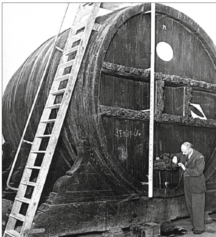
Il. 2. Tzw. beczka-matka o pojemności 37 437 litrów służąca do jednorazowego przygotowania dużej ilości wina przeznaczonego do wtórnej fermentacji w butelkach, fot. ze zb. Muzeum Ziemi Lubuskiej
