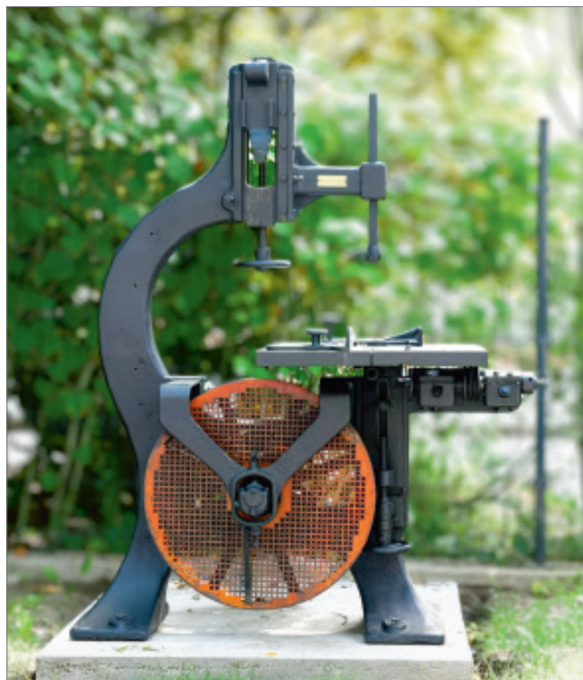
Wielofunkcyjna maszyna stolarska, Alwin Kirsten, Maschinenfabrik „Diamant”, Leipzig–Wahren
